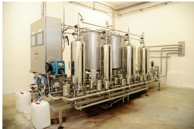
Notre palette de filtration est dimensionnée selon vos besoins. Manuelle ou automatique, nous définissons le skid selon les débits et les seuils de filtrations voulu afin d'optimiser les vitesses des fluides tant sur les phases de process que sur les phases de nettoyage. Avec ou sans dosage en ligne. Un système d'enregistrement peut être intégré, en autonomie ou sur le réseau du client, de même qu'un système de télémaintenance.
