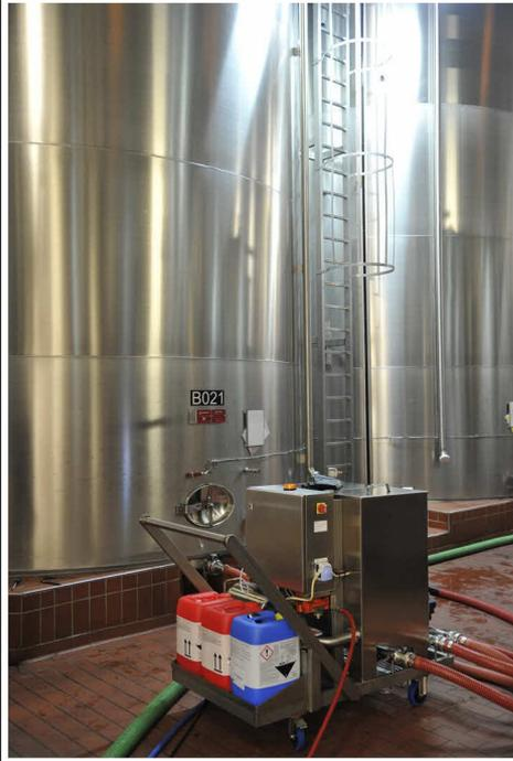
**Le NEP mobile** programmable gère le lavage de vos cuves et de vos équipements de façon **autonome**. Une fois programmée, il procède aux différentes étapes de dosage, lavage et rinçage sans intervention humaine. Le NEP mobile possède l'instrumentation nécessaire au **contrôle** pour assurer l'**optimisation** du nettoyage sa validation ainsi que sa **traçabilité**. Un outil **qualité** qui diminue vos consommations et libère votre personnel.
