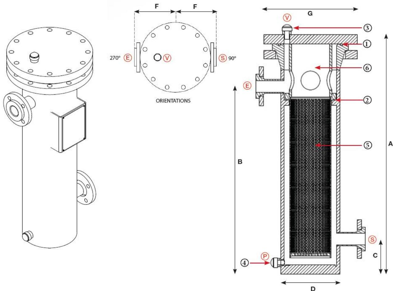
**KIT JOINT DE RECHANGE** comprenant : 2 joints de couvercle (1) + 1 joint de panier (2) + 2 joints d'évent (3) + 2 joints de purge (4)
